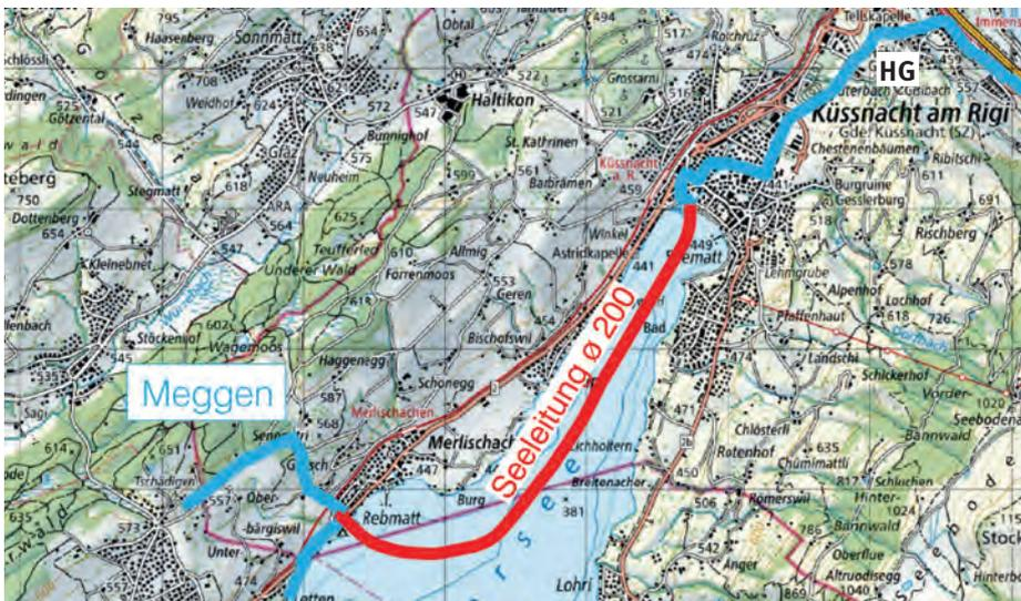
Das neu erstellte Teilstück der Transportwasserleitung Meggen von der Hohlen Gasse in Immensee (HG) durch das Dorf Küssnacht bis zum Schieberschacht in Merlischachen. Rot markiert die neue Seeleitung von Küssnacht bis Merlischachen.
